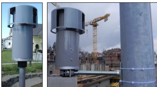
Abbildung 1: Sigma-2 Passivsammler mit Rohrbefestigung (links) und Sigma-2 Passivsammler mit Bridenbefestigung (rechts).
