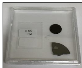
Abb. 2: Sigma-2 Haftoberfläche mit Glassubstrat für Lichtmikroskopie (links) und C-Pad und Bor Substrat für REM Analysen (rechts)
