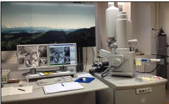
Abb. 1: Rasterelektronenmikroskop (REM)
