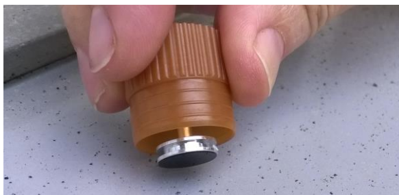
Probenahme auf einem Fenstersims mittels Stempel
